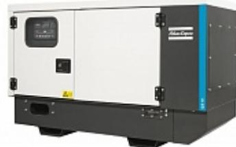
Дизельный генератор QIS 10 мощностью 9/7,2 кВт при основной нагрузке, имеет ёмкость топливного бака 55 литров и его топливная автономность при сто процентной нагрузке составляет 22 часа. Двигатель Kubota D1105-BG-50HZ, объёмом 1,12 литров обеспечивает экономичную и, относительно, мало шумную работу генератора.
