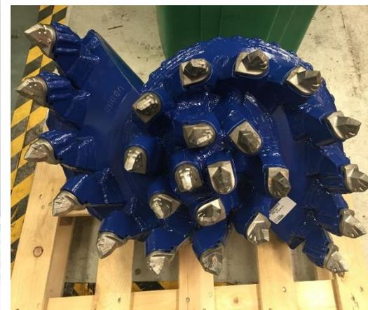
**ADU 1500 на 30 тонном экскаваторе, диаметр шнека 700 мм, бур головка оснащена резцами «зуб дракона»**
